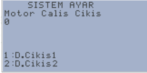
Şekil 2.19 Motor Çalıştırma çıkışının fiziksel bağlantı seçim ekranı
