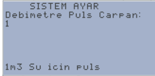
Şekil 2.18 Debimetre Pulse Çarpım ekranı
